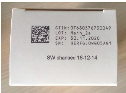
Obr. 5 Ukážka 2D Data matrix čiarového kódu na obale lieku, z ktorého je vidieť, že v kóde sú zakódované okrem číslic aj písmená aj špeciálne znaky
